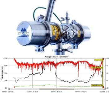
測定範囲：0.1 μm-2,500 μm
