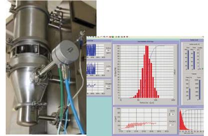
測定範囲：50 μm-6,000 μm
