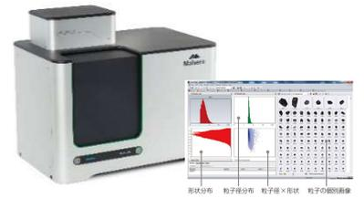
測定範囲：0.5 μm-1,300 μm
